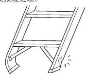
**3** 天板和踏板是否出现弯曲、凹陷。 若出现弯曲、凹陷现象**请勿再使用**, 建议报废处理。
