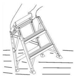
3. 打开作业台后, 手离操作杆。最后 再确认一下锁扣是否确实锁住。
