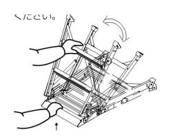
**②**请移动操作杆检查锁扣有无确实锁 定。不能确实锁定的情况下,**请勿再 使用**,建议报废处理。
