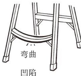
**④** 各部件的连接处是否出现破损、严重腐蚀等现象。另外，安装的零部件是否出现破损、脱落、变形、磨损、严重腐蚀等现象。
