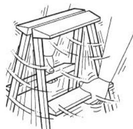
② 请检查锁扣是否确实锁定。不能确实锁定的情况下，**请勿再使用**，建议将其报废。
