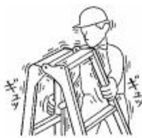
③ 请确认左右锁扣有无确实锁定。
