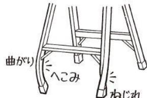
③ 踏板是否出现弯曲、凹陷的现象。若出现弯曲、凹陷现象**请勿再使用**，建议报废处理。
