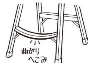
④ 各部件的连接处是否出现破损、严重腐蚀等现象。以及，零部件是否出现破损、脱落、变形、磨损、严重腐蚀等现象。若出现上述现象**请勿再使用**，建议报废处理。
