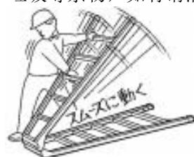
② 左右的关节（旋转金属零件）是否有松动或晃动现象。
