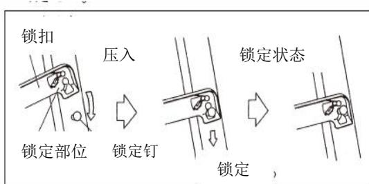
③ 标准型号的人字梯的左右锁扣如右图所示，按↓所指位置向下压，确保将锁扣确实锁定。
