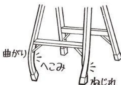
③ 踏板是否出现弯曲、凹陷。若出现弯曲、凹陷现象**请勿再使用**，建议报废处理。
