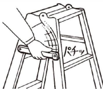
② 左右的关节(旋转金属零件)是否有松动或晃动现象。
